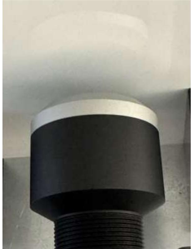
Le récepteur SPECTRO-M-2-2.95/3.90 est ici dirigé vers un film semi-transparent. (L'émetteur SPECTRO-M-15-T se trouve sur le côté opposé).
