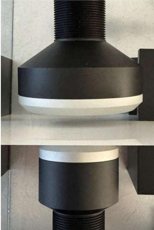
Mesure par transmission MIR de l'épaisseur d'une couche de vernis avec l'émetteur SPECTRO-M-15-T (source de lumière) et le récepteur SPECTRO-M-2-2.95/3.90.
